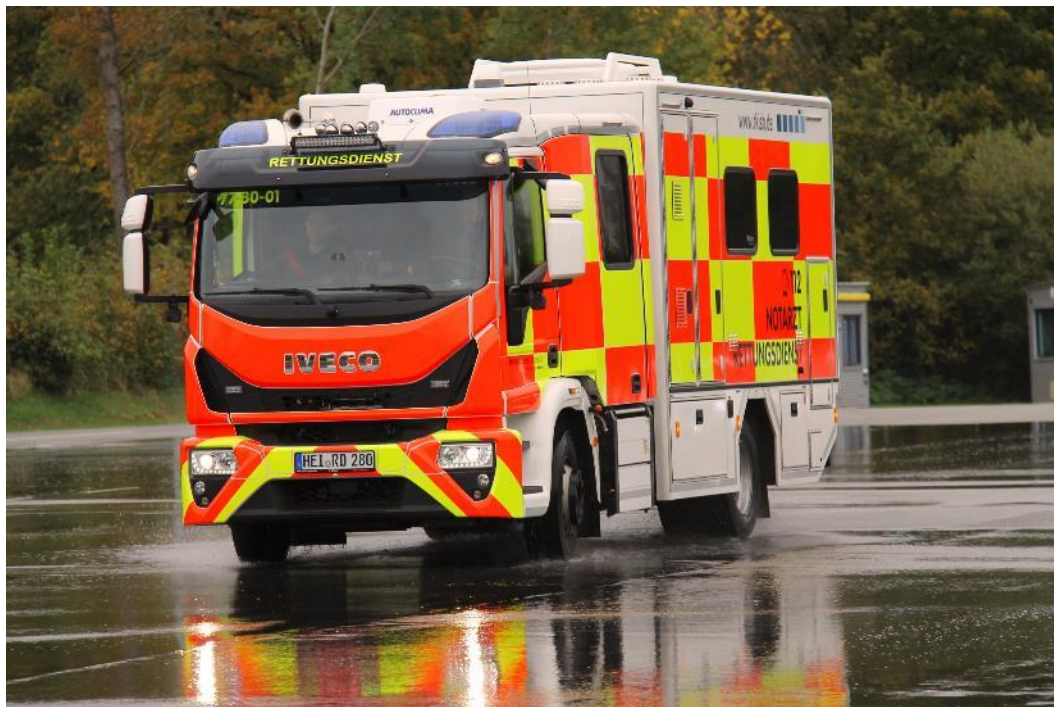
Der ITW ist 8,17m lang, 3,40 m hoch und 2,55 m breit. Er wiegt 12 Tonnen und hat 280 PS.
